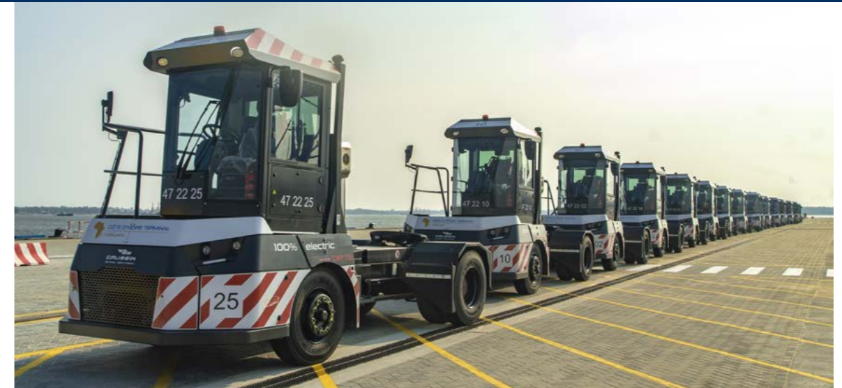
Tracteurs 100% électriques, Abidjan, Côte d'Ivoire Terminal.
